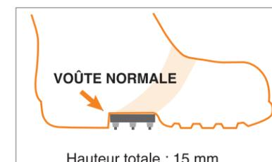
Plateforme standard en caoutchouc et crampons de longueur normale, idéals pour la plupart des bottes de travail avec un talon marqué ou compensé
