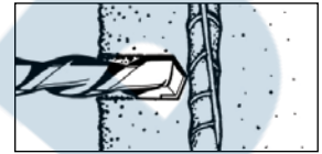
1. Arrêter le foret au contact d'une barre
