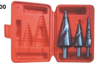
La conception en cône étagé offre un meilleur contrôle du diamètre des trous dans les matériaux d'une épaisseur jusqu'à 1/8". Perçage en une étape pour jusqu'à 13 diamètres de trous différents. Les trous sont ébavurés en découpant le rebord pour le prochain diamètre supérieur. Idéal pour la tôle et l'agrandissement des trous.
